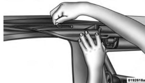
11. Insira o retentor frontal da janela na canaleta da porta verificando se ele está totalmente encaixado e posicionado corretamente na estrutura da porta. Se isso não for feito, poderão ocorrer vazamentos de vento e água ou danos à janela.
