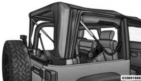
9. Instale parcialmente os retentores do painel sulcado na canaleta lateral da carroceria deixando ao menos 7,6 cm (3 pol.) soltos no sentido do vidro traseiro (nos dois lados). Se o arco traseiro do teto for puxado para baixo (arco 3), isso ajudará a alcançar a canaleta com os retentores.
