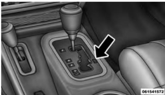
**Tampa de Acesso da Substituição da Alavanca de Câmbio**
