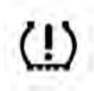
Cada pneu, inclusive o sobressalente (se fornecido), deve ser verificado mensalmente quando está frio e cheio para ver a pressão de enchimento recomendada pelo fabricante do veículo na etiqueta do veículo ou na etiqueta de calibragem dos pneus. (Se seu veículo estiver com pneus de tamanho diferente do indicado na etiqueta do veículo ou na etiqueta da pressão de enchimento dos pneus, verifique a pressão de enchimento adequada para eles.)
