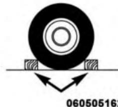
6. Calce as partes dianteira e traseira da roda em posição diagonalmente oposta à do macaco. Por exemplo, se você for trocar o pneu dianteiro direito, calce o traseiro esquerdo.
