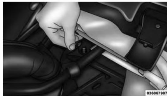
4. Usando o reforço plástico como uma alavanca, deslize a correia de fixação do arco lateral (ambos os lados).
