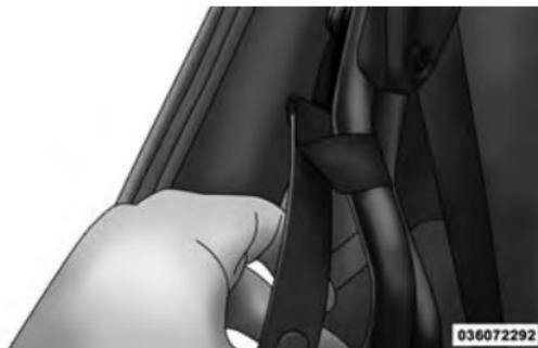
9. Abotoe a correia de fixação do arco lateral (ambos os lados).
