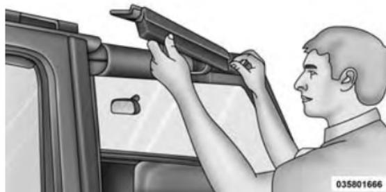
6. Prenda a parte frontal do trilho da porta na barra lateral tomando cuidado para que o material da cobertura da barra lateral não seja esmagado pela estrutura da porta.
