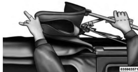
16. Dobre a capota de modo que o material forme um "W" conforme mostrado. Entre no veículo e mova o material para as duas dobras.
