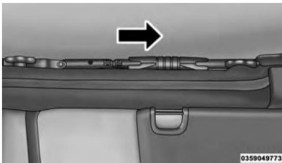
4. Segure a cabeceira e levante a capota para trás. Verifique se o material está dobrado conforme mostrado.
