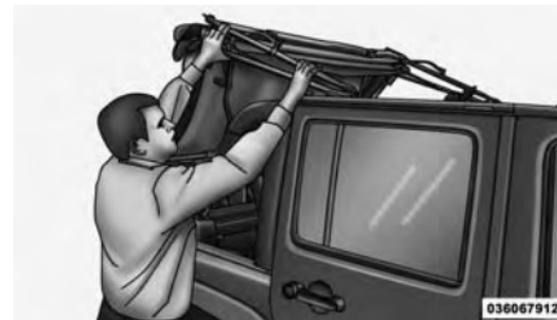
19. Deslize cuidadosamente os arcos laterais para fora do trilho da estrutura da porta e abaixe a capota no veículo.
