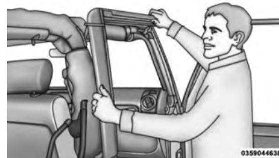
3. Depois de ajustar o pino da estrutura da porta no orifício no lado da carroceria, ajuste cuidadosamente a frente da estrutura da porta no vedante de borracha na parte superior do para-brisa.
