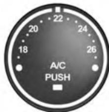
Ajuste a temperatura na qual deseja que o sistema mantenha, girando o botão giratório de Controle de Temperatura. Quando o nível de conforto for selecionado, o sistema irá mantê-lo automaticamente usando o sistema de aquecimento.
