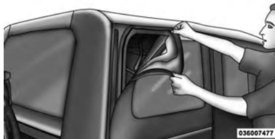
10. Depois de abrir o zíper, remova os retentores do vidro lateral da canaleta da porta e da canaleta lateral da carroceria. Repita essa etapa no lado oposto.
