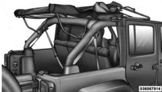
13. Os suportes da porta do bagageiro não precisam ser removidos, a menos que a capota rígida esteja sendo instalada. Para remover os suportes da porta do bagageiro, puxe a parte frontal do suporte para frente enquanto rola o suporte inteiro na direção do veículo para desencaixá-lo.
