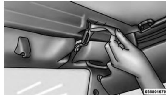
7. Se os suportes da porta do bagageiro tiverem sido removidos, instale-os prendendo a borda posterior do suporte no lado interno da canaleta da carroceria. Em seguida, gire para trás e sobre a canaleta até que sejam fixados na parte externa do trilho. Para ser posicionado corretamente, o suporte só deve ser preso à borda do trilho reduzido.
