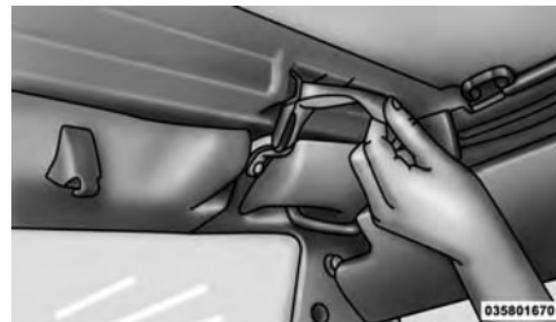
4. Solte os retentores do painel sulcado da canaleta lateral da carroceria nos cantos inferiores do veículo.
