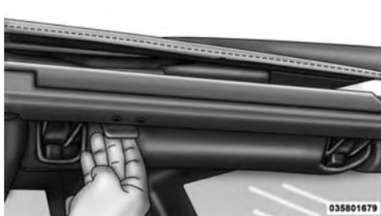
17. Antes de baixar a capota, abra a porta do bagageiro para evitar possíveis danos à luz de freio montada na parte traseira superior central. Vá até a frente do veículo. Segure o arco lateral atrás da cabeceira e levante a capota, dobrando-a na parte traseira do veículo.
