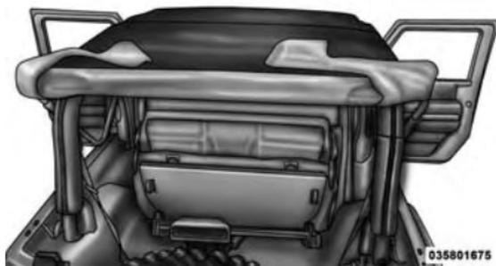
13. Os suportes da porta do bagageiro não precisam ser removidos, a menos que a capota rígida esteja sendo instalada. Para remover os suportes da porta do bagageiro, puxe a parte frontal do suporte para frente enquanto rola o suporte inteiro na direção do veículo para desencaixá-lo.
