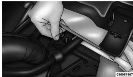
10. Remova a barra da porta do bagageiro (barra de metal preta da parte inferior do vidro traseiro) e coloque de lado.
