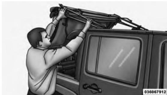
6. Certifique-se de que a capota se encaixe nos mecanismos de travamento do Sunrider® localizados acima da parte frontal das portas traseiras.
