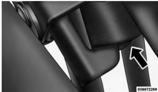
8. Usando o reforço plástico como uma alavanca, remova a correia de fixação do gancho do suporte deslizando a correia para fora do gancho e deslizando para baixo o arco lateral (ambos os lados).
