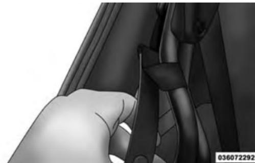
5. A correia de fixação **deve** ser enganchada no suporte de pivô antes da remoção da capota flexível do veículo (ambos os lados).
