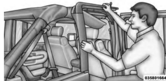
3. Posicione a parte superior da estrutura da porta na barra esportiva de metal e pressione na barra lateral tomando cuidado para não esmagar o material de cobertura da barra esportiva e garantir que esteja posicionado corretamente na vedação acima da frente da porta traseira.
