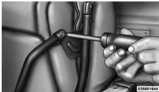
4. Desconecte as juntas dos suportes de pivô de metal esquerdo e direito. Remova a capota flexível do veículo e guarde em local limpo e seco.
