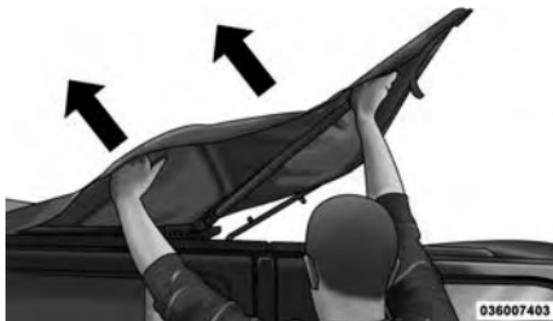
4. Dobre para trás a seção frontal da capota e coloque cuidadosamente a cabeceira sobre a área superior da parte traseira do compartimento.
