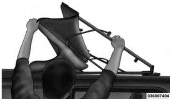
5. Dobre a capota de modo que o material forme um "W" conforme mostrado. Entre no veículo e mova o material para as duas dobras.
