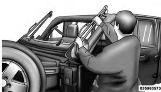
5. Insira o componente deslizante das juntas dos trilhos da estrutura da porta e deslize a capota para frente.
