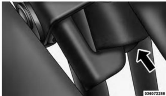
6. Remova os parafusos de suporte de pivô do conjunto do arco da capota flexível (dois em cada lado) da barra esportiva usando uma chave de boca ou chave de soquete de 10,0 mm.
