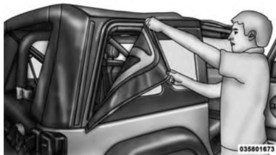
10. Depois de abrir o zíper, remova os retentores do vidro lateral da canaleta da porta e da canaleta lateral da carroceria. Repita essa etapa no lado oposto.
