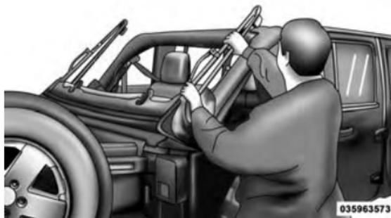
20. Dobre o tecido e as correias de verificação entre os arcos para a parte mais interna possível. Isso evitará que qualquer parte da capota fique solta para fora do veículo.
