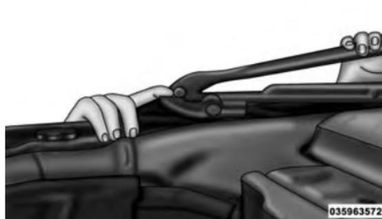
18. Antes de baixar a capota, abra a porta do bagageiro para evitar possíveis danos à luz de freio montada na parte traseira superior central. Segure os arcos laterais dobrados e deslize a capota ao longo do trilho da estrutura da porta até a estrutura da porta traseira.
