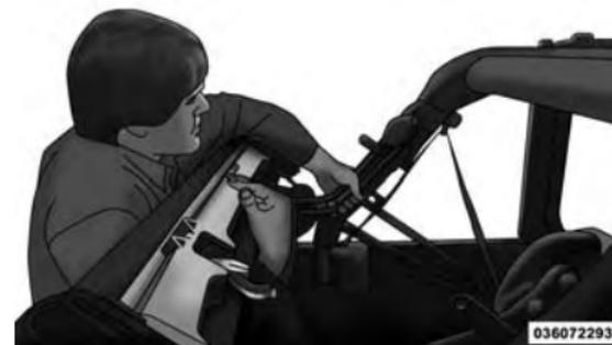
9. Reinstale a capota rígida. Consulte Capota Rígida Modular de Três Peças "Freedom Top™ – Instalação do Painel Dianteiro/Traseiro" nesta seção.
